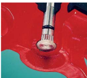
Spodní čep pevně uložen v tělese
