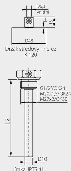
■ MONTÁŽ SNÍMAČE A JEHO OBSLUHA
