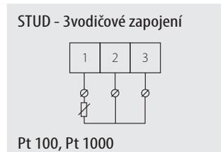
Pozn.: Pro 2vodičové zapojení musí zkratovací propojka mezi svorkami 1 a 3 zůstat zapojená.
